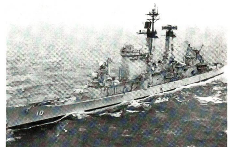
Der Raketenkreuzer «USS Albany» auf voller Fahrt im Mittelmeer. Er verdrängt maximal 18 000 t, ist 205 m lang, läuft 33 Knoten und verfügt über zwei 12,7-cm-Geschütze, zwei Doppelstarter für Talos- und zwei Doppelstarter für Tartar-Lenk Waffen, sechs Torpedorohre und einen Achtfachwerfer für Anti-U-Boot-Raketen.
