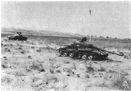
Sowjetischer Panzer T-62. Dieser Kampfpanzer ist mit einer 115-mm-Kanone ausgerüstet, die zwei Munitionsarten verschossen kann: APFSDS (Armor Piercing, Fin-Stabilized, Discarding Sabot = Flügelstabilisiertes Wuchtgeschoss mit Treibspiegel) und HEAFS (High Explosive, Antitank, Fin-Stabilized = Flügelstabilisiertes Hohlladungsgeschoss)
