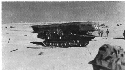
Sowjetisches Brückenbaugerät auf PT-76-Schwimmpanzer-Fahrgestell.
