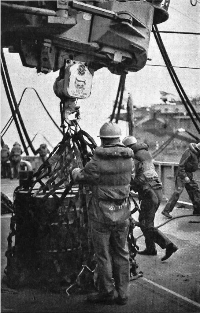
änner in bunten Helmen und mit Schwimmweste befestigen die mit Gütern ladenen Netze an den Laufkatzen, die dann von der «Seattle» zur «Ken- dy» gefahren werden. Im Hintergrund sieht man diverse Ölleitungen.
