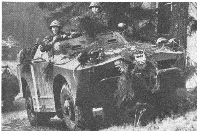
Russischer Schützenpanzer BRDM. Gewicht 6 t; Besatzung 2 Mann + 4 Panzergrenadiere; Bewaffnung 1 Mg; Panzerung 11 mm; schwimmfähig; Geschwindigkeit auf Strassen 65 km/h, im Wasser 15 km/h.
