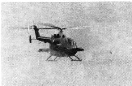
Abschuss einer schweren drahtgesteuerten HOT-Panzerabwehrwaffe der zweiten Generation ab einem leichten Mehrzweckhubschrauber BO-105. Bei einer Vorwärtsgeschwindigkeit des Trägerflugzeugs von wenigstens 180 km/h erreicht der HOT-Flugkörper eine Reichweite von 4000 m. Die 22 kg schwere Lenkwaffe besitzt einen 6 kg schweren Hohlladungsgefechtskopf, der alle bekannten Fahrzeugpanzerungen glatt durchschlägt.
