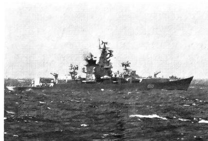
Ein «Kresta-II»-Raketenkreuzer auf Marsch im Mittelmeer. Auffallend ist die verhältnismässig flache Schiffsilhouette mit Ausnahme des massiven kombinierten Radar- und Schornsteinmastes. Am Heck ist der Helikopterhangar gut sichtbar. Vorne und achtern stehen die leeren Boden-Luft-Lenk Waffenstarter.
