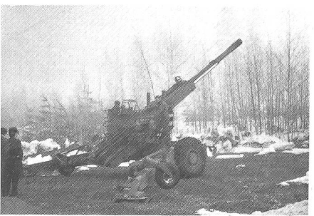
An der Feldhaubitze 77, 15,5 cm, ist unser Land interessiert. Dank eigenem Antrieb fährt die Haubitze nach der Trennung vom Zugfahrzeug «selber» in Stellung.
