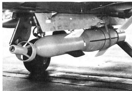
Matra integriert in Zusammenarbeit mit Thomson-CSF den Eblis-Laserzielsuchkopf zu einem Laserlenkrüstsatz für konventionelle 250- bis 1000-kg-Mehrzweckbomben. Der Rüstsatz trägt die Bezeichnung BGL und umfasst einen Laserdetektor, elektronische und elektromechanische Komponenten für die Einsatzsteuerung sowie eine Heck-
