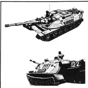
abgeschrägte Front, Einheits-fahrgestell (PT-76), feste Kasematte mit 85 mm-Pak, Richtbereich: 15 Grad Höhe und 6 Grad Seite, Kan mit Mündungsbremse und Rauchabsauger, 1 MG koaxial mit Hauptwaffe, 1 FlabMG, IR-Ausrüstung, nicht amphibisch
