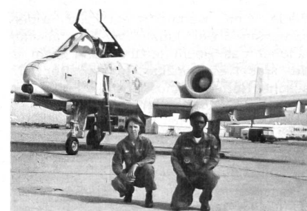
Während des «Air Tattoo» auf der Luftwaffenbasis Greenham Common zeigte die US Air Force erstmals den Erdkämpfer A-10 Thunderbolt II, der speziell zur Bekämpfung von Panzern vorgesehen ist. Unter der Nase ist die Mündung der siebenläufigen Revolverkanone (Gatling-Gun, Kaliber 30 mm) zu erkennen. Demnächst soll auch eine zweisitzige Version dieser Maschine gebaut werden. Man beachte die zur Bodenmannschaft gehörende Mechanikerin Mary Keim.
