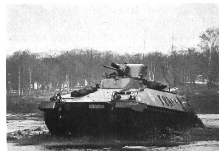
Schützenpanzer Marder – Gefechtsfahrzeug der Panzergrenadiere – mit 20-mm-Bordkanone im Gelände
