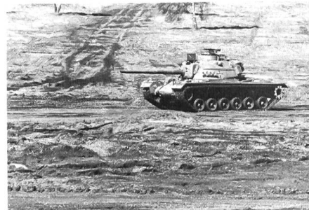
Auf 105-mm-Kampfwagenkanone umgerüsteter Kampfpanzer vom US-Typ M-48
