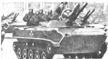
5 kleine Laufräder, 4 Stützrollen, Turm wie BMP-1, doch völlige Neuentwicklung des Fahrzeugs, hochgezogener, zugespitzter Bug mit je einem 7,62 mm-MG in den Ecken, hinter dem Turm offene Sitzplätze für 6 Mann
