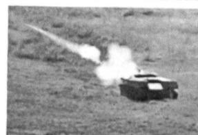
Abfeuern einer Raketengranate (425 m/s) und anschliessende Zündung des Raketenmotors (Beschleunigung auf 700 m/s)
