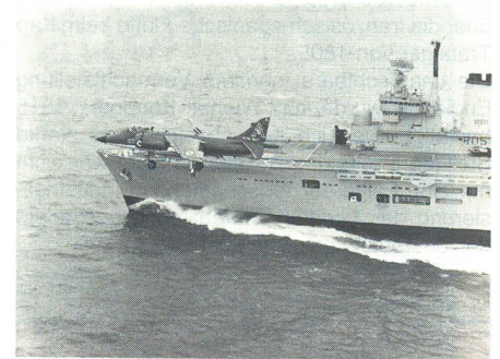
Drei sogenannte «Trough deck cruisers» sollen die konventionellen Träger der Royal Navy ablösen. Auf dieser Aufnahme ist das erste, im Jahre 1980 in Dienst gestellte Schiff der «Invincible»-Klasse (mit gleichlautendem Namen) zu erkennen. Die «Invincible» ist 207 m lang und verdrängt 16 257 t, die Besatzung zählt total 903 Mann. Im Vordergrund «schwebt» ein Senkrechtstarter des Typs «Sea Harrier», von dem inskünftig eine Staffel mit 5 Maschinen an Bord stationiert sein wird.
