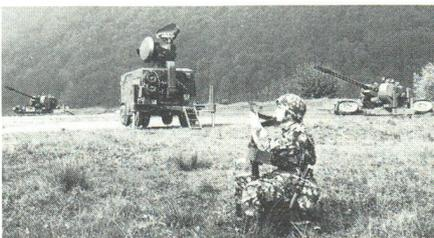
Das Feuerleitgerät 75 Skyguard (Bildmitte) bewährt sich bestens als mobiles Allwetter-Flabsystem mit besonderer Eignung zur Bekämpfung von Tieffliegern. Skyguard steuert die beiden 35 mm Fliegerabwehrschütze auch auf überraschend auftauchende Luftziele.
