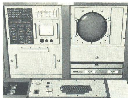
Der Trainingsimulator TS 2 für die Ausbildung der Truppe am Feuerleitgerät 75 Skyguard. Dank diesen Simulatoren können teure Flugstunden gespart, Fluglärm vermieden und trotzdem alle möglichen Situationen wirklichkeitsgetreu geprobt werden.
