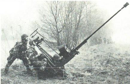
Die leichte Flab mit ihren 20 mm Kanonen ist in hoher Masse zur Abwehr von Helikoptern geeignet. Das einfache, robuste Waffensystem und die taktische Mobilität zeichnen die leichte Flab aus.
