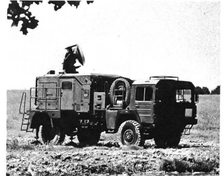
FIELDGUARD in Messstellung
