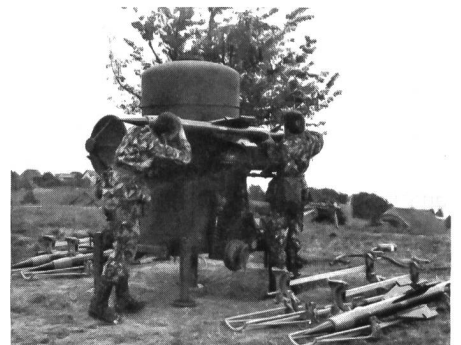
Beladung der RAPIER-Lenkwaaffe durch zwei Mann ohne mechanische Hilfe.
