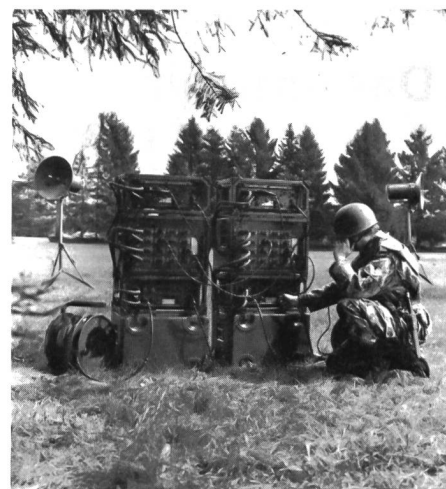
Das von Siemens-Albis AG, Zürich, besonders für die Erfordernisse der Landesverteidigung entwickelte Delta-Multiplexsystem Albis DMS 15/63 erlaubt eine optimale Ausnutzung bestehender und zukünftiger Übertragungsmittel.
