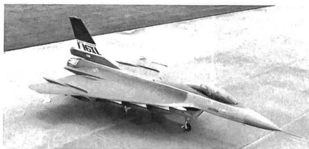
24 Stunden nach dem Rollout startete in Fort Worth die erste Mustermaschine des Typs F-16XL zu ihrem Erstflug. Die auf dem F-16 Fighting Falcon basierende Maschine mit einer 80prozentigen Teilgleichheit und einer doppelt so grossen Flügelfläche unterscheidet sich von der ersteren hauptsächlich durch folgende technische Charakteristiken:
