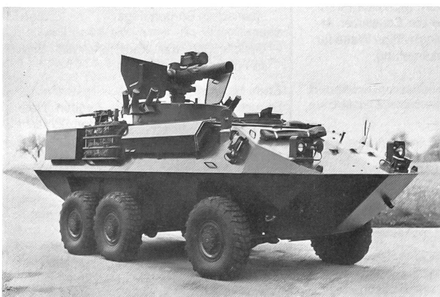
Piranha Panzerjäger 85 mit der ausgefahrenen TOW 2 Säulenlafette. Die beiden Lukendeckel beidseitig des TOW 2 Startrohres dienen sekundär auch noch zum Schutz des Lenkwaffenschützen. Links und rechts der Lukendeckel sind die Nebelwerfer zu sehen, dahinter das MG 51.
