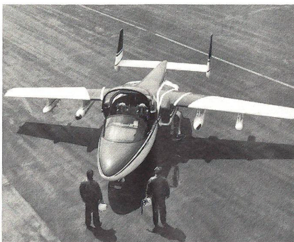
Basierend auf dem neuen Strahltrainer T-46A der USAF schlägt Fairchild eine für den Exportmarkt ausgelegte Version FRC-225 vor. Der von zwei Strahltriebwerken Garrett F109-GA-100 angetriebene Hochdecker ist in der Lage, an bis zu vier Unterflügelstationen Waffen und Brennstoffzusatzbehälter im Gesamtge-
