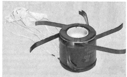
MUSPA - Splitterladung mit passiver Sensorik; über Fallschirm gebremster Flug; Bekämpfung von rollenden und startenden Flugzeugen sowie Pistenreparaturfahrzeugen.
