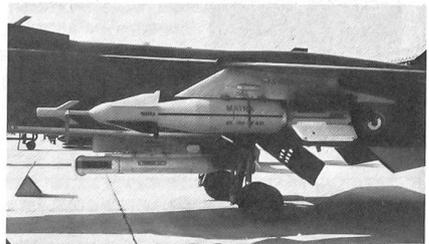
Basierend auf den beim Bau des Laserlenkrüstsatzes BGL für die Bestückung von 400-kg-Mehrzweckbomben gewonnenen Erfahrungen entwickelte Matra in Zusammenarbeit mit SAMP eine für die Hartzielbekämpfung optimierte 1000 kg schwere Laserlenkbombe. Die auf unserer Foto an der rumpfnahen linken Unterflügelstation eines Jaguar-Erdkämpfers befestigte
