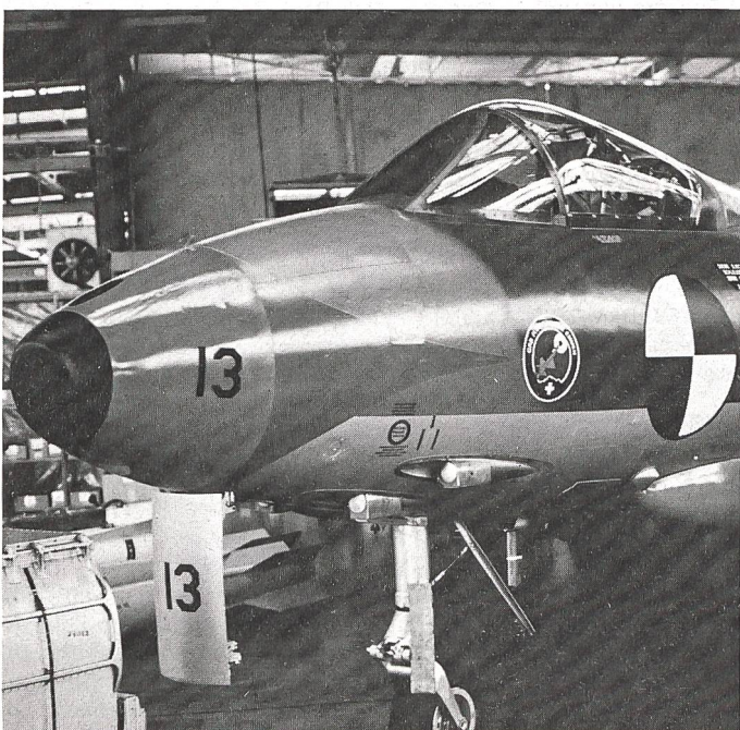
Nahaufnahme des GRD-Hunters, ausgestattet mit einer speziellen Kameranase.
