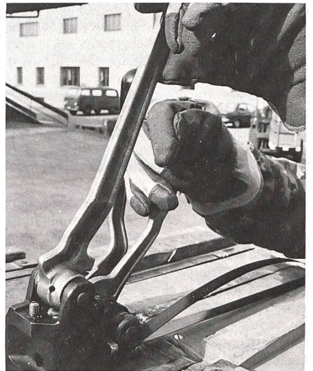
14 «Baverschlapp»-Bandverschlussapparat, den ein Munitionssoldat im Palettierdienst beherrschen lernt.
