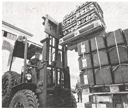
10 Der 6,2 Tonnen schwere «Steinbock»-Gasta (Gabelstapler) kann Lasten bis zu 2 Tonnen tragen. Oberstes Gebot im Alltag: Sicherheit geht voran.
