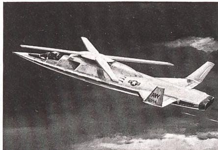
Unsere obige Aufnahme zeigt eine Modellfoto des Experimental-Fluggerätes S-72X1, das mit je zwei Strahltriebwerken GE-T58-GE-10 für den Antrieb des Rotors bzw GE-TF34-GE-400A für den Vorwärtsschub ausgerüstet ist. Das folgende Illustriatorbild veranschaulicht eine mögliche Serienversion für Geschwindigkeiten bis zu Mach 0,8. Als mögliche Einsatzrollen werden Luft- und Erdkampf-, Frühwarn-, elektronische Aufklärungs-, U-Bootbekämpfungssowie Such- und Rettungs-Missionen genannt. ka
