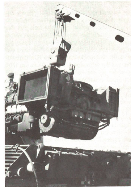
Motorenwechsel beim Panzer Leo 1.
