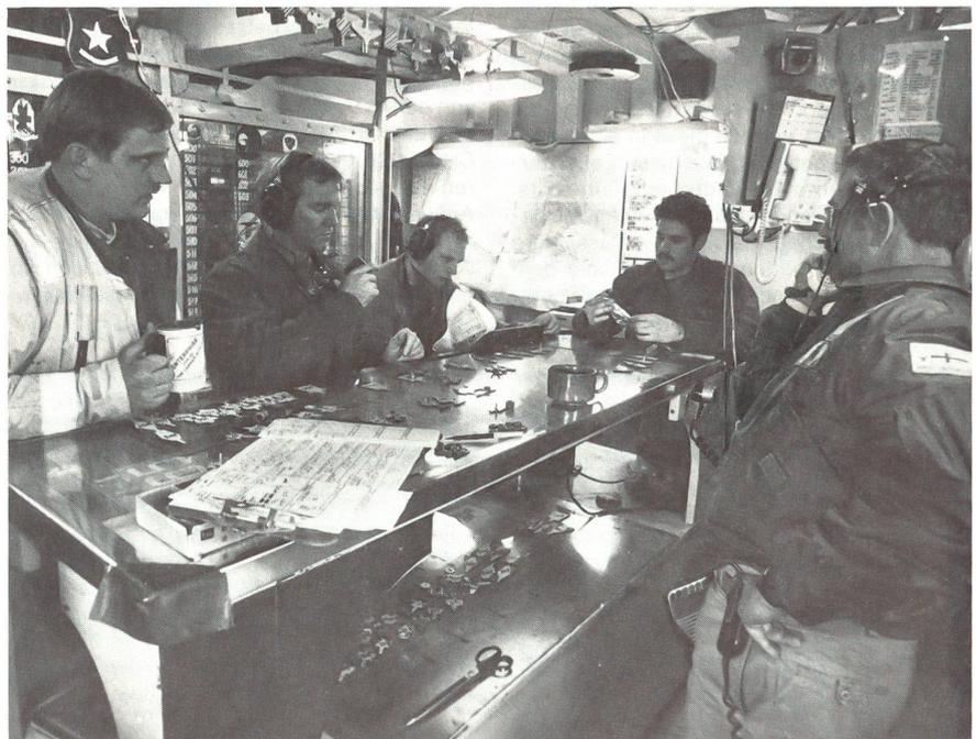
Um eine Kontrolle über die Standorte jeder einzelnen Maschine auf der «Enterprise» zu haben, wird jede einzelne Bewegung mittels Telefon in diese Kontrollzentrale (Flight Deck Control) gemeldet, wo sie mittels Modellen nachvollzogen wird. Die engen Verhältnisse und die gegen 90 Flugzeuge auf dem Träger zwingen zu diesem rationalen Betrieb.
