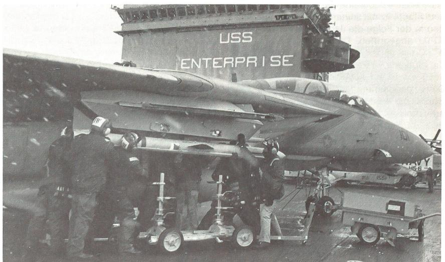
Im leichten Schneetreiben wird ein F-14A-«Tomcat»-Abfangjäger der Staffel 114 «Fighting Aardvarks» mit einer Luft-Luft-Lenkwanne des Typs «Sparrow» bewaffnet. Im Hintergrund ist der Turm des atomgetriebenen Flugzeugträgers «Enterprise» erkennbar.
