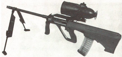
LMG-Version des AUG mit einem Nachtsichtgerät
