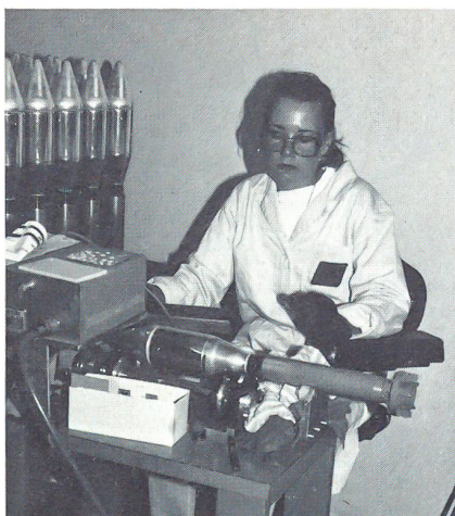
Abdichten des Gefechtskopfes der HPz Rak 89 mit Dichtungsmittel
