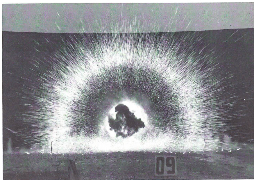
Detonierende 6-cm-Spl Br G auf dem Prüfstand
