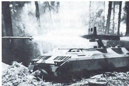
die Steuersignale über ein Feuerleitsystem mit Sensorkomponenten der Firma Texas Instruments erhält. Der Kinetic Energy Missile (KEM)-Flugkörper arbeitet mit KE-Penetratoren im Ziel. Das Modellbild zeigt den Abschuss eines LOSAT-FK aus einer abklappbaren Startlafette von einem modifizierten SPz-Fahrgestell M2 «Bradley» aus. Oberhalb der Abschusslafette sind die Tag/Nacht-Sensoren für die Feuerleitung montiert. Aus «Soldat und Technik» Nr 8/91
