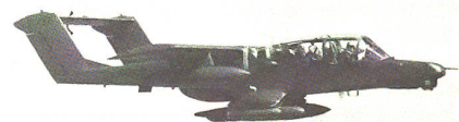
OV-10 BRONCO: die zweimotorige Turbopropmaschine mit dem typischen, hochgesetzten «Gabelschwanz» ist als Zielzuweiser und als leichter Erdkampfer (und Helikopterjäger) über irakischen Stellungen in Kuwait im Einsatz.
