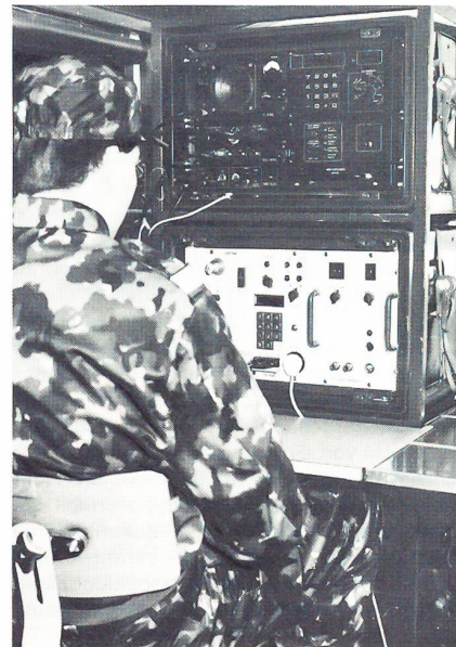
Die Kommandofunkstation SE-430 für den drahtlosen Schreiberverkehr. Sie zeichnet sich durch einfache Bedienung und hohe Verbindungszuverlässigkeit aus.
