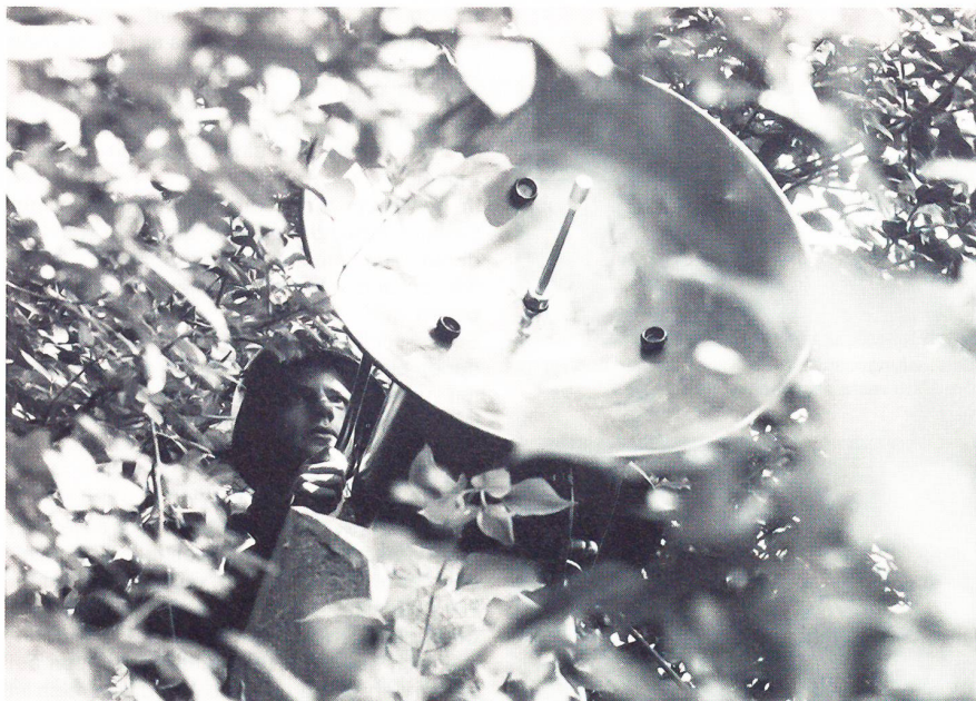
In den siebziger Jahren eingeführt und Mitte der achtziger voll digitalisiert (zur voll verschlüsselten Übertragung), leistet die handliche Richtstrahlstation R-902 noch auf Jahre hinaus hervorragende Dienste, beispielsweise auf Stufe Division.
