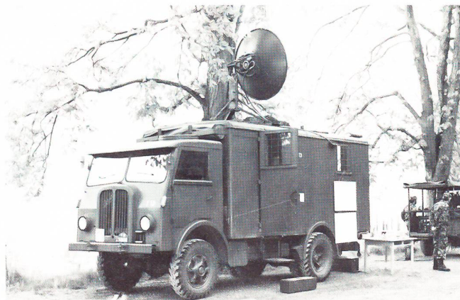
Mit vorwiegend stationären Grossrichtstrahlstationen RB-1111 wurde in den sechziger Jahren das landesweite Richtstrahlnetz aufgebaut. Die betagte Station soll in nächster Zukunft durch die moderne Nachfolgerin R-915 abgelöst werden.
