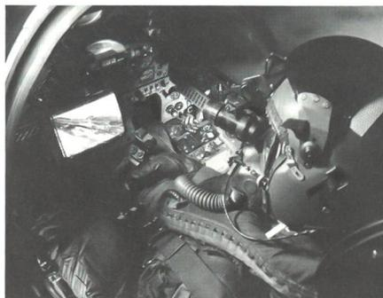
Wellenlängen im Bereich von 10 Mm abgeben. Da keine Umgebungsbeleuchtung erforderlich ist, arbeitet das Wärmebildgerät auch bei vollkommener Dunkelheit.
