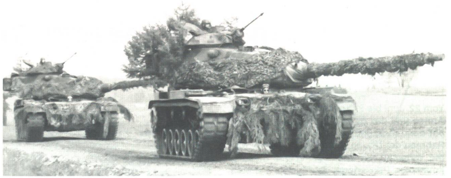
Panzerzug mit Kampfpanzern M-60A3 (Kampfgewicht 51,5 t; Besatzung 4 Mann; Bewaffnung: 10,5 Kanone, 12,7-mm- und 7,62-mm-Maschinengewehre, Motor: 550 kW; Höchstgeschwindigkeit: 48 km/h; Fahrbereich: 500 km auf der Strasse). Sie waren die Gegner der schweizerischen Panzerjägerkompanie.
