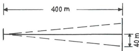
erlangen. Mit seiner Hilfe ist es möglich, eine Marschrichtung im Gelände einzuhalten. Kompassmärsche sind aber risikoreich und nur in Ausnahmesituationen berechtigt, da Richtungsabweichungen von 10% und mehr zu erwarten sind.
