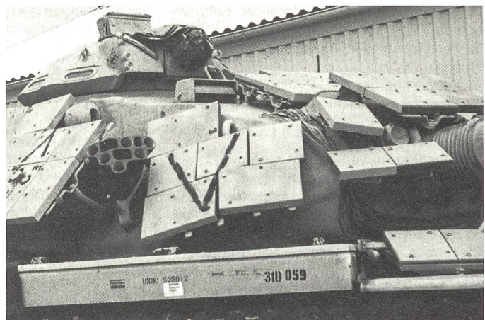
Ein Kampfpanzer des amerikanischen Typs M-60 A3, wie er von Teilen der 1. und 2. Marineinfanteriedivision eingesetzt wurde. Diese beiden Verbände waren aus Süden zwischen den zwei arabischen Korps auf Kuwait gestossen. Der Turm ist mit zusätzlichen Stahlplatten versehen, um Hohlladungsgeschosse vorzeitig zur Explosion zu bringen.
