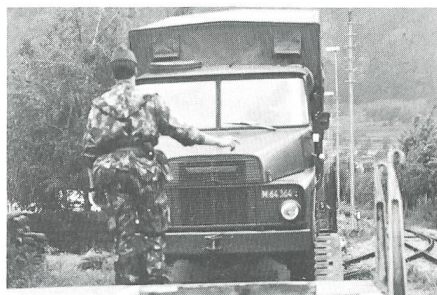
Kpl Haldemann beim Einweisen des 1. Fz auf dem Zug. Es ist ein Henschel, der nur auf Tiefladewagen transportiert werden kann.
