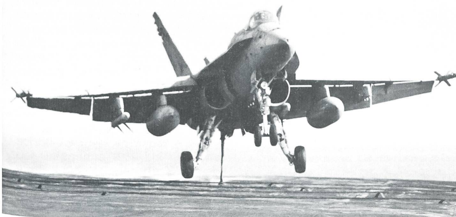
Eine F/A-18C « Hornet » der Fighter/Attack Squadron 87 « Golden Warriors » landet auf dem Deck des US Flugzeugträgers « USS Theodore Roosevelt » (CVN-71). Sie kehrt von einem Einsatz zur Überwachung der « No Fly Zone » über Bosnien-Herzegowina zurück. Gut sichtbar sind der Fanghaken zwischen dem Fahrwerk sowie die über das Flugdeck gespannten Fangseile. Die F/A-18 C ist mit einer Luft-Luft-Lenkwanne « Sparrow » sowie an den Flügelenden mit « Sidewinder »-Luft-Luft-Lenkwanne bewaffnet.
