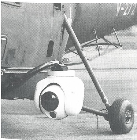
Alouette III mit Wärmebildkamera FLIR.
