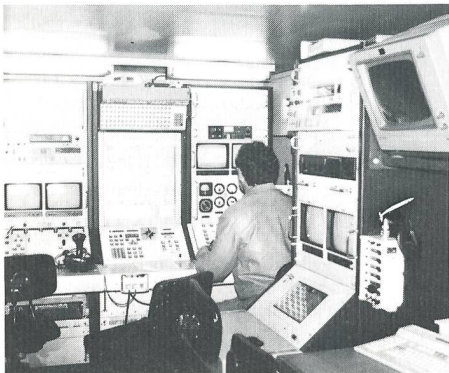
Blick in den Leitstand der Drohne. Der Pilot überwacht und steuert deren Flug. Auf dem Kartenausschnitt ist die Position und Flugrichtung permanent ersichtlich.
