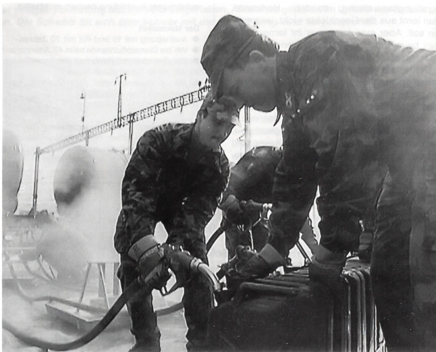
Abfüllen von Betriebsstoffkanistern ab Eisenbahnzisternen.
