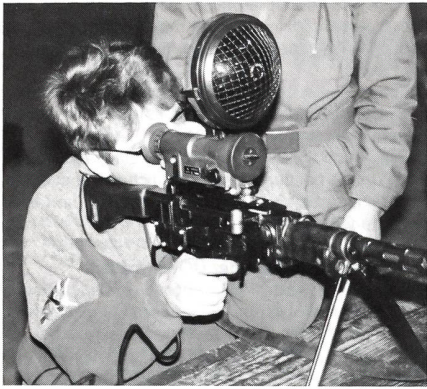
Mit dem Infrarot-Beobachtungs- und Zielgerät zum Sturmgewehr 57 kann man auch bei vollständiger Dunkelheit zielen und treffen.
