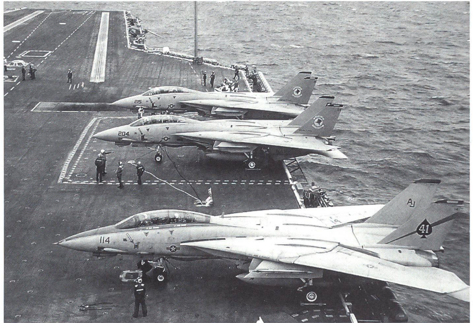
Zu den Kampfflugzeugen an Bord der USS John C. Stennis gehören auch diese F-14 A-Tomcat-Jagdbomber der Fighter Squadrons 14 und 41, die hier auf dem Vorschiff der USS John C. Stennis auf den Katapultstart warten. Am oberen Bildrand sind die beiden Katapulte Nr 1 und 2 erkennbar.
