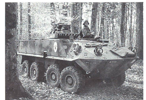
Das neue Transportmittel – der Schützenpanzer 93. Am Turm vorne sind die Nebelwurfbecher zu erkennen.
