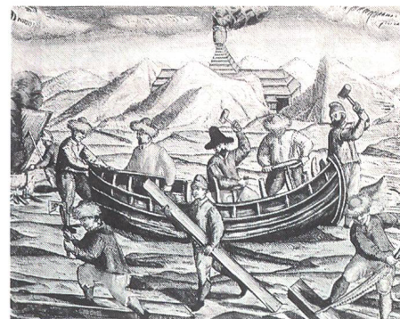
Vorbereitung zur Rückfahrt im offenen Boot: Die Wände werden aus Planken des aufgegebenen Schiffes erhöht.
