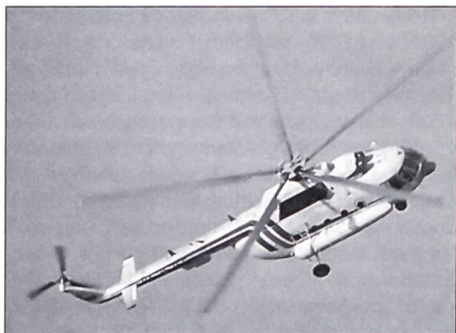
Mittelschwerer russischer Transporthubschrauber Mil Mi-171 (Weiterentwicklung der Mi-17 mit stärkeren Triebwerken).
