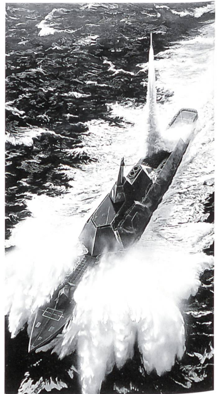
Das Bild zeigt einen Entwurf für ein «Arsenal»-Schiff der Firma Lockheed-Martin. Vor der Brücke mit den besonderen Konturen eines geringe Radarschatten erzeugenden Schiffes ist die besonders grosse Zahl von Startkanistern für die Marschflugkörper ersichtlich.
