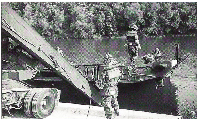
Sorgfältig wird ein Brückenmodul ins Wasser gelassen.
