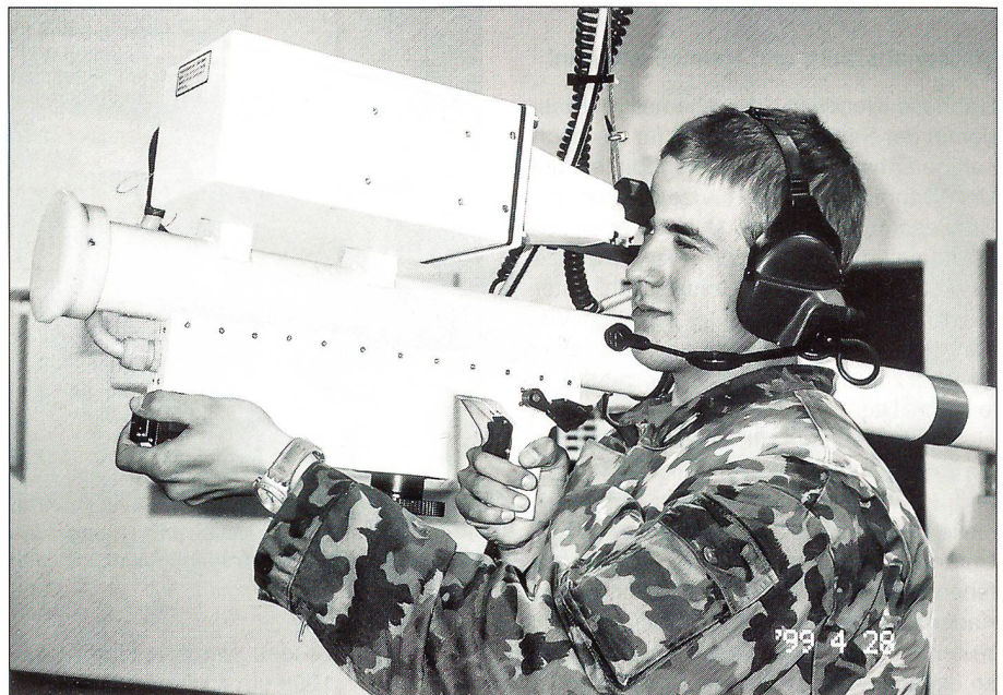
Der Stinger-Sim im Einsatz. Der Schütze sieht im Monitor die von der Software dargestellte Landschaft, die Zielvorrichtung und Zielhilfen und das Fluggeschehen. Über Kopfhörer empfängt er echte Motorengeräusche und andere wichtige Infos. Mit der linken Hand hält der Schütze die Kreislösetaste und mit der rechten Hand den Abzug.
