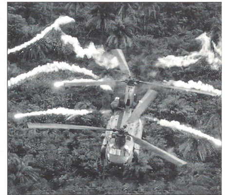
Mittelschwerer Transporthubschrauber Boeing Chinook HC Mk.2 der RAF, ausgerüstet mit Miniguns und Flares.
