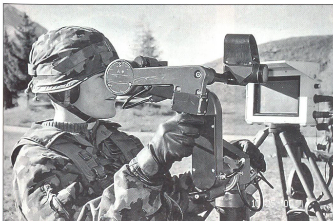
Korporal Marco Herbst, Emmen, überwacht an der Richtfehleranzeige die Arbeit des Schützen. Im Hintergrund die zum Geschütz gehörende Anzeigestation.
