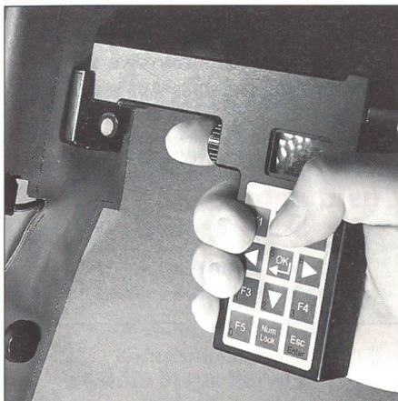
Die Schiedsrichtereinheit wird für die folgenden Funktionen gebraucht: Eingabe von Übungsdaten, Abfragen (Übernahme) der gespeicherten Übungsdaten, Einflussnahme auf Übungsablauf wie Neutralisation oder Neueinsatz eines Teilnehmers.
