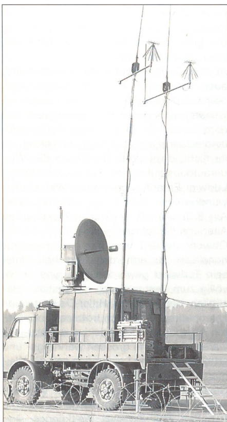
Mobile Bodenstation, aufgebaut auf einem Saurer 10DM.
