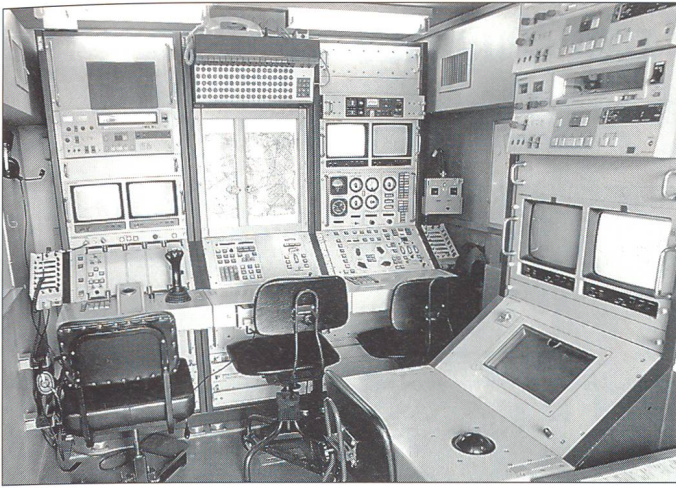
Die Einsatzkontrollstation ADS 95 mit den Arbeitsplätzen (v. l.) für Nutzlastbediener, Navigator, Pilot und Benutzervertreter ist in einem Container auf einem Saurer 10DM untergebracht. (Bilder GR/SF/FUsid).
