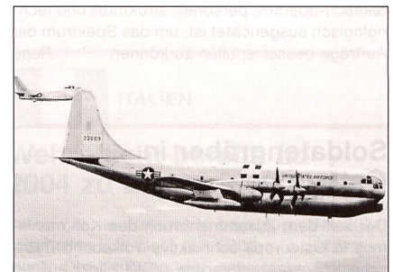
Boeing YC-97G Stratocruiser der USAF, ausgerüstet mit 4 Turboprops YT-34P-5 mit je 5700 PS; im Hintergrund eine North American F-86F Sabre
